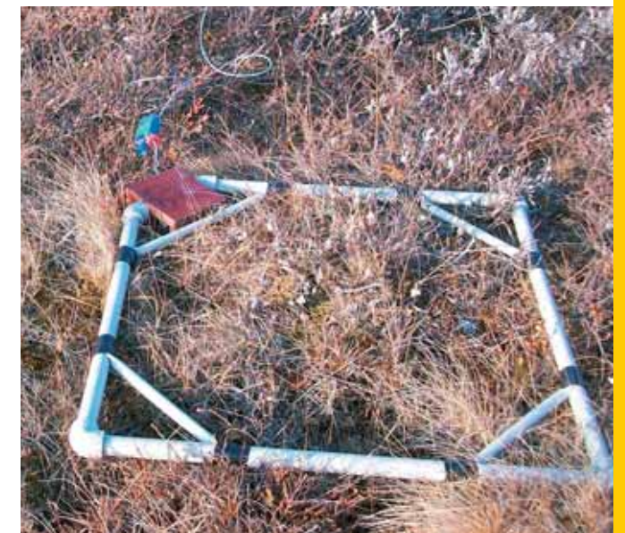
Оборудование для зондирования становлением поля в ближней зоне. Приемный датчик ПДИ-50 – эквивалент петли 50×50
