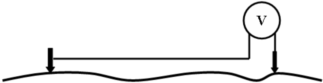
Рис. 2. Электроразведочная установка для измерения естественного электрического поля.
