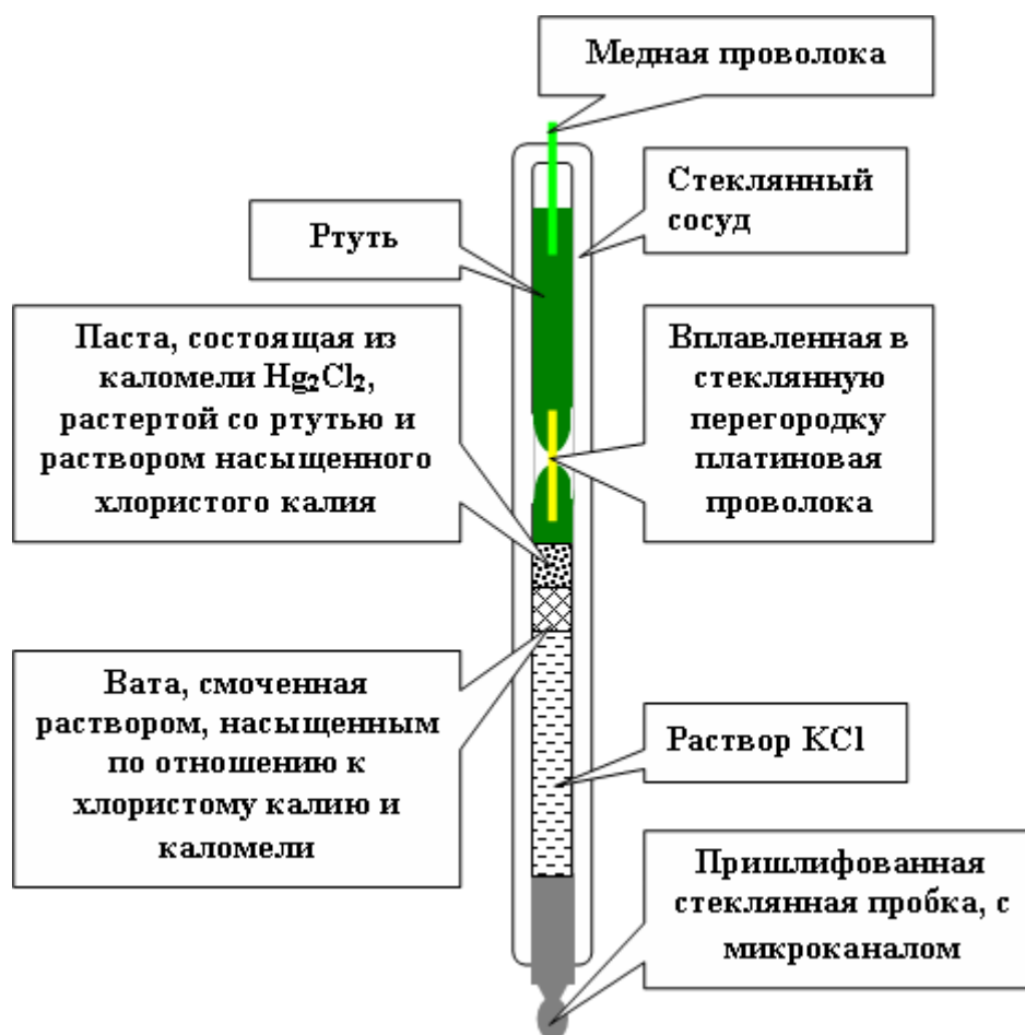
Рис. 13. Устройство каломельного электрода.
