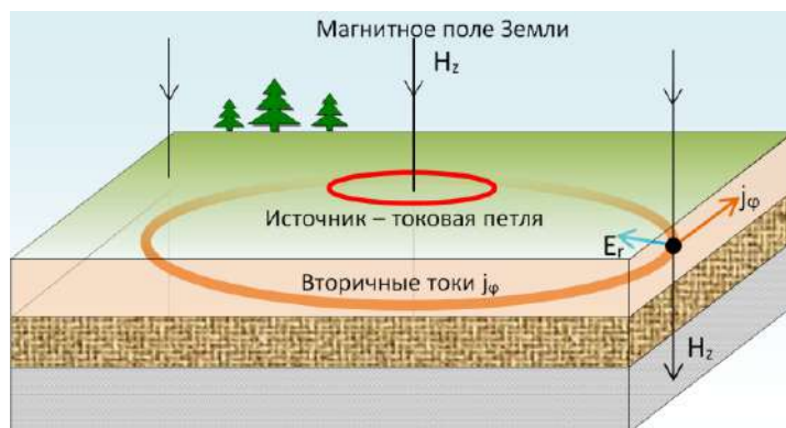
Рис. 1. Появление холловской напряженности E_r электрического поля
